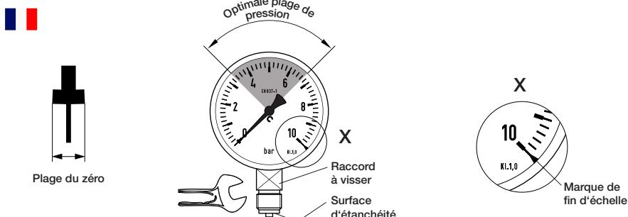
Le point de mesure de la pression doit être préparé selon les indications pour les taraudages. Voir également les indications supplémentaires selon les directives de VDE/VDI 3511 et 3512 page 3 et la norme EN 837-1/2. Les joints selon DIN 16258 conviennent pour l'étanchéité du montage. Le couple de serrage correct dépend de la matière et de la forme du joint utilisé. Il ne devrait pas dépasser 80 Nm.
