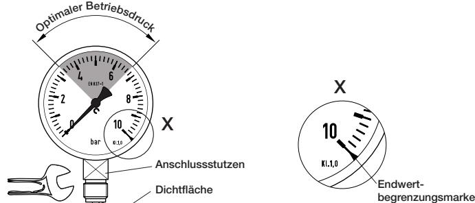
Die Druckentnahmestelle sollte entsprechend den Angaben für Einschraublöcher vorbereitet werden. Weitere Hinweise erhalten Sie in der VDE/VDI-Richtlinie 3511 und 3512 Blatt 3 und der EN 837-1/2.
